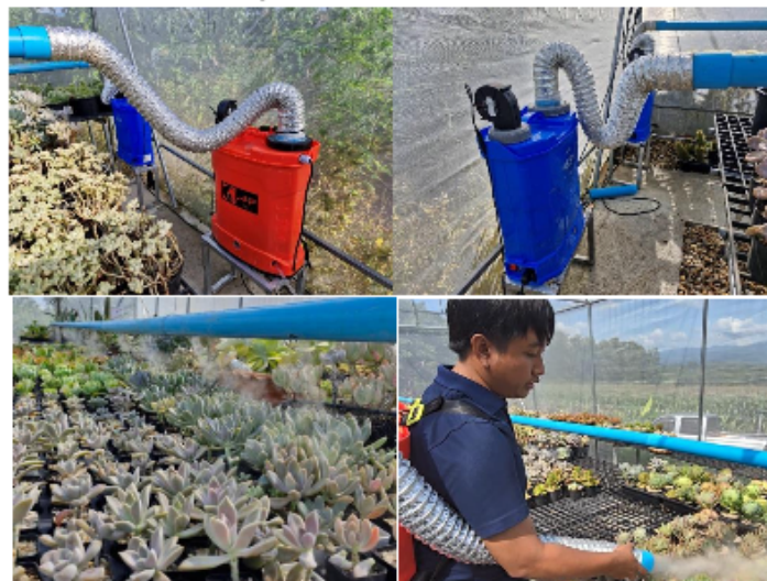
ภาพที่ 3.7 การติดตั้งเครื่องกำเนิดละอองน้ำขนาดเล็ก ณ วิสาหกิจชุมชนไม้ดอกเมืองพริ้ว
