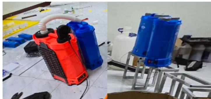
ภาพที่ 3.6 การประกอบอุปกรณ์ เครื่องกำเนิดละอองน้ำขนาดเล็กจำนวน 4 ตัว
