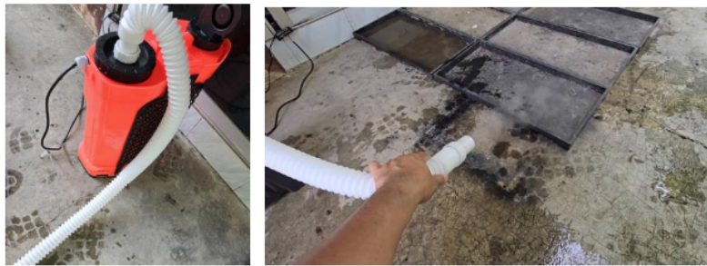
ภาพที่ 3.5 การทดสอบเครื่องพ่นหมอกโดยใช้พลังงานจากแบตเตอรี่
