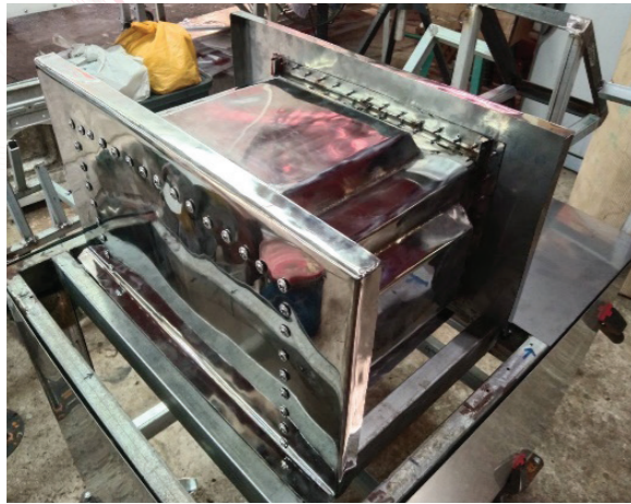
ภาพที่ 1 ตัวห้องทอดข้าวเกรียบทำจากแตนเลสเกรด 304 สำหรับใช้กับอาหารได้
