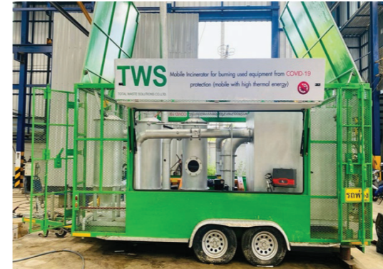
ภาพที่ 1 นวัตกรรมเตาเผาสำหรับเผาวัสดุอุปกรณ์ที่ใช้แล้วจากการป้องกันเชื้อ Covid-19
