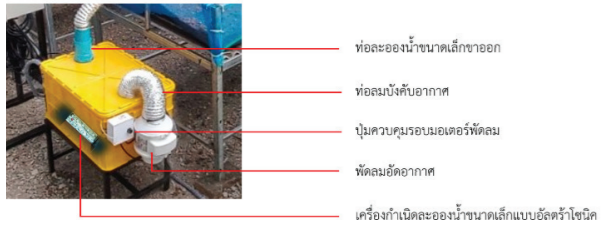
ภาพที่ 3 ลักษณะของหัวพ่นละอองฝอยขนาดเล็ก และชุดต้นแบบเครื่องกำเนิดละอองน้ำขนาดเล็ก
