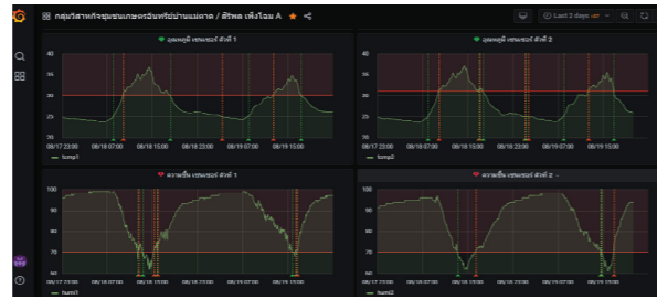
ภาพที่ 3 แสดงหน้าจอการแสดงผลของโปรแกรม Sensor Box of Insect (SBI) ซึ่งสามารถแจ้งเตือนผ่านระบบ line ของกลุ่มเป้าหมายได้
