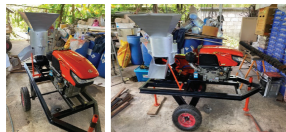
ภาพที่ 4 เครื่องอัดเม็ดปุ๋ยมูลสัตว์ วิสาหกิจชุมชนเกษตรชุมชนบ้านสองแคว
