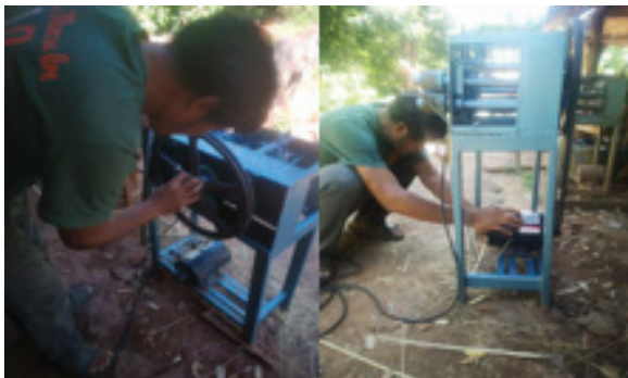
ติดตั้งมอเตอร์และพู่เลย์
