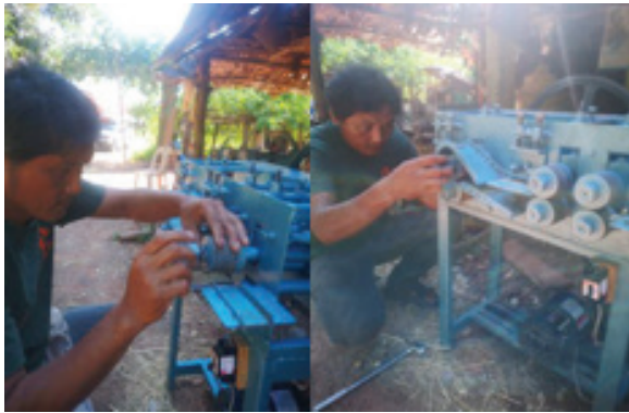
นำชุดประคองลูกกลิ้งและชุดลูกกลิ้ง มาสวมกับไกด์
