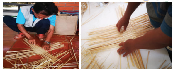
การนำเส้นตอกมาจักสานเพื่อรอขึ้นรูปภาชนะ
