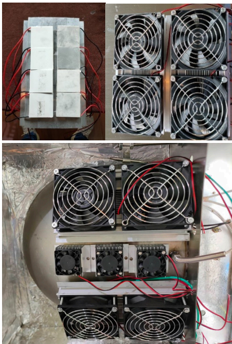
ภาพ การประกอบเพลทเทอร์โมคอนดักทีฟ heatsink พัดลมและตำแหน่งการติดตั้ง
