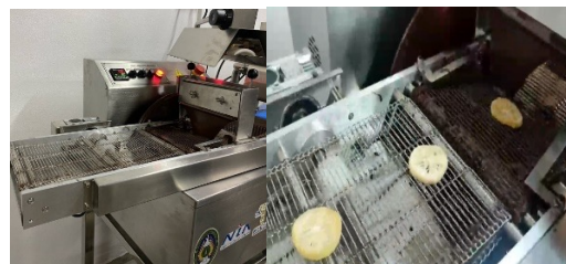
ภาพ การเคลือบช็อคโกแลตโดยใช้เครื่องเคลือบช็อคโกแลตขนาดเล็กโดยใช้แหล่งกำเนิดความร้อนและเย็นจากแผ่นเพลทเทอร์โมคอนดักทีฟ
