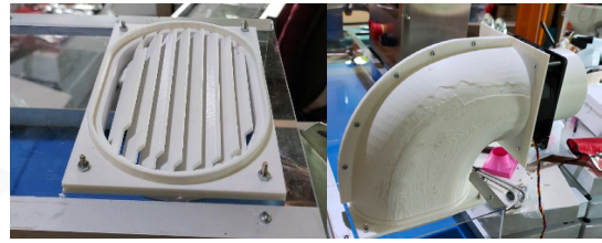
ภาพ การขึ้นรูปพลาสติกด้วย 3D printing
