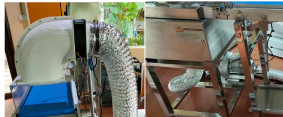
ภาพ การติดตั้งพัดลมและการต่อท่อสำหรับอุโมงค์ทำความเย็น
