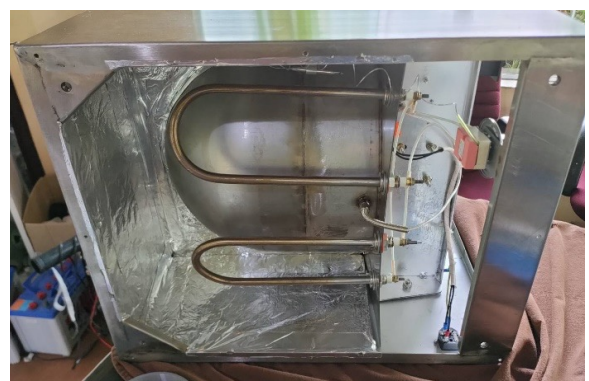
ภาพ แสดงรูปแบบการติดตั้งขดลวดความร้อน
