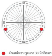
ภาพที่ 4 ตำแหน่งและระยะการเจาะรูกระจายละอองน้ำขนาดเล็กเพื่อใช้ในการปลูกสตรอเบอรี่อินทรีย์
