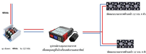
ภาพที่ 8 แสดงการเชื่อมต่ออุปกรณ์ระบบระบายอากาศเพื่อลดอุณหภูมิในโรงเรือนพลังงานแสงอาทิตย์
